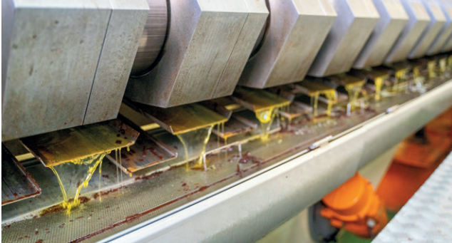
Auspressen der erwärmten Kakao­masse mithilfe der hydraulischen Presse
