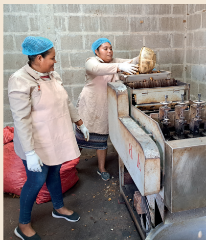
Maschine, die die Cashew-Schalen knackt, mit den Mitarbeiterinnen Cristian Mabel und Zuaso Paladino.
